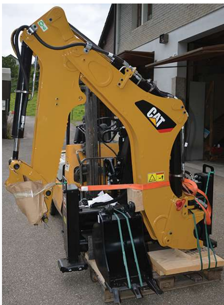
Baggerarm mit Schaufel hinten für Erdarbeiten
