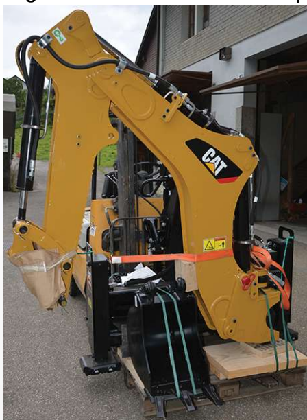
Rétro-pelleteuse pour le terrassement
