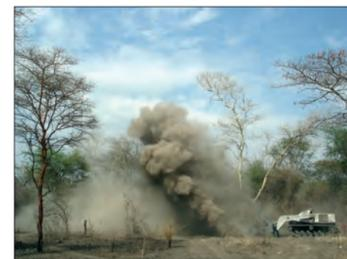
Digger hat ein anderes Ausbaggerungssystem mit Hartmetallspitzen entwickelt. Unser dritter D-2 ist derzeit damit ausgerüstet. So können die Minenräumer je nach Bodenbeschaffenheit das bestgeeignete Werkzeug gleich selber auswählen.
