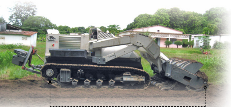
L'information provenant du couple de l'outil corrige automatiquement la vitesse d'avance.
