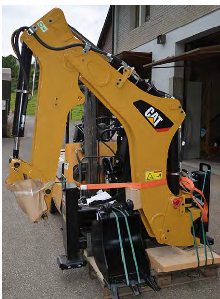
Baggerarm mit Schaufel hinten für Erdarbeiten
