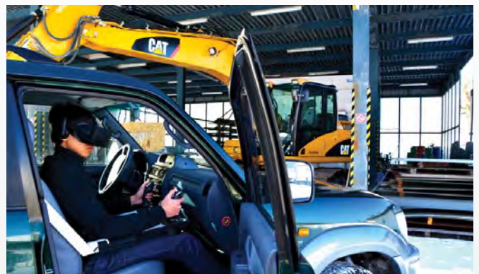
Der Bediener kann den Bagger aus sicherer Distanz steuern (siehe Kasten).
